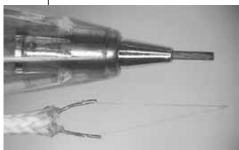
先端が25ミクロンの極細熱電対
